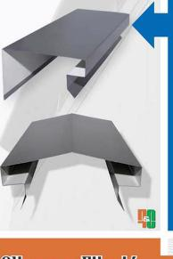
Lagrimales Este elemento tiene por objeto proteger los remates de los muros en las edificaciones, evitando que generar humedades internas y deterioro de muros y revoques. **Longitud:** 2.44 m. **Calibre:** 26 - 24 - 20 -18 Desarrollo: 0,60 m.m. Acabado: Epoxico más esmalte.
